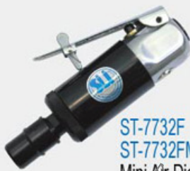
ST-7732 1/4" ST-7732M 6mm Mini Air Die Grinder Speed: 25,000 rpm
